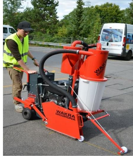
Der Trockenschnittfugenschneide **DICORONA BS259** ist speziell für den Einsatz um Schneiden von Arbeitsfugen und Induktionsschleifen (Signalbau) entwickelt worden. Sie ist äußerst wendig. Der Trockenschnitt hat klare Vorteile gegenüber dem Nassschnitt. Keine Verschmutzte Fahrbahn dank der integrierten Staubabsaugung. Sie haben stets eine saubere, ausgekehrte Fuge und keine Belastung der Kanalisation durch Schneidschlämme. Der Trockenschnitt ist zurzeit im Schwarzbelag möglich
