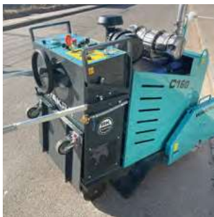
Sollbruchstelle mit Wakra, vier Zentimeter tief geschnitten.
