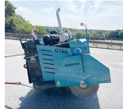
Der C160 von Wakra: ein lenkbarer Dieselfugenschneider im Nasschnittverfahren.
